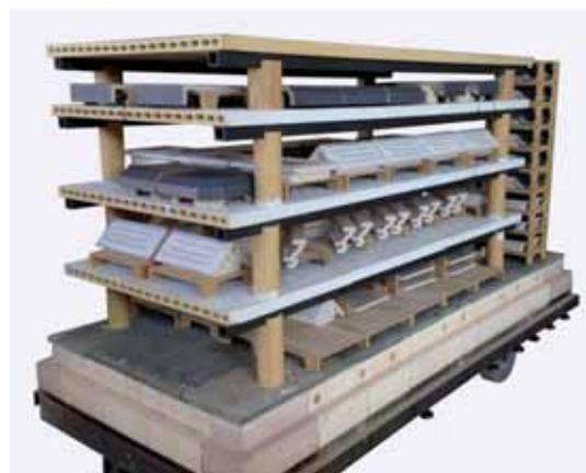
Plaques extrudées (plaques creuses) 1850 x 850 x 38 mm
