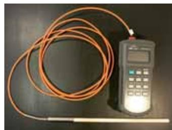
Kit thermomètre à pile type S
