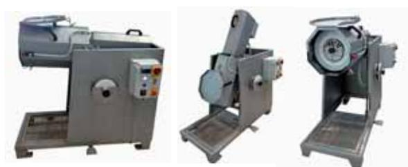
Broyeur avec jarre de 25 litres en différentes positions MGS25S01
